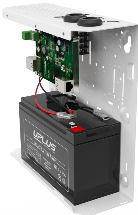
Bilden visar PoE injector 1p S med batteri, (medföljer ej)
